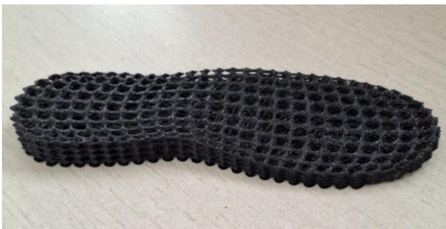
Fig. 3. Suela impresa en 3D mediante FGF.
