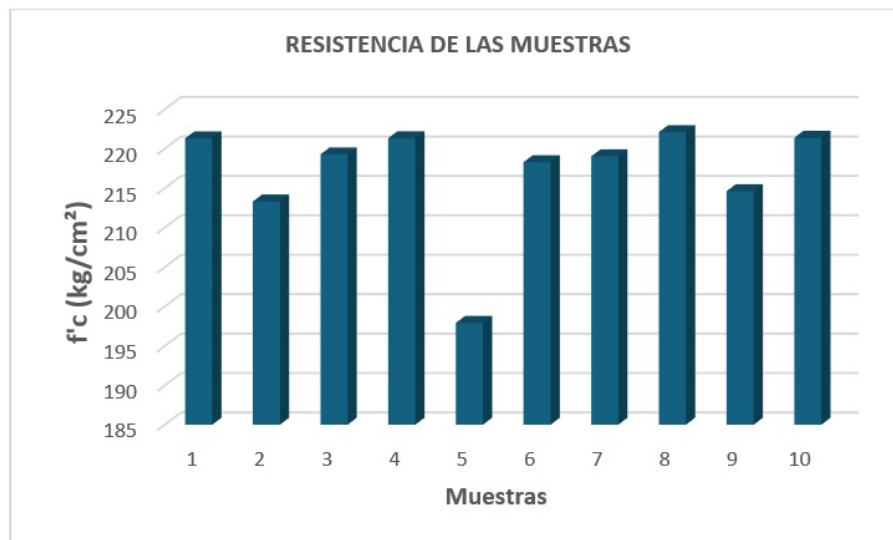
Fig. 2. Resistencia a la compresión de las muestras, Holcim.
