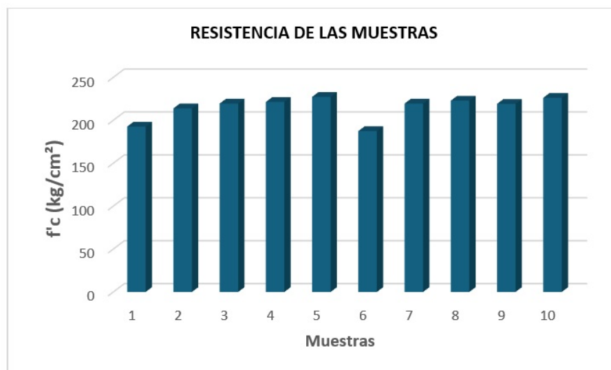
Fig. 1. Resistencia a la compresión de las muestras, Selvalegre.
