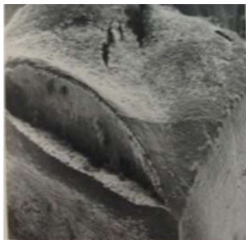
Fig. 2. Aspecto de grieta en muestra de \text{Fe}_2\text{O}_3\text{-Fe}_3\text{O}_4 , A 900^\circ\text{C} -100% \text{NH}_3 , 29,1 % Reducción y 25,95% incremento de volumen [2].
