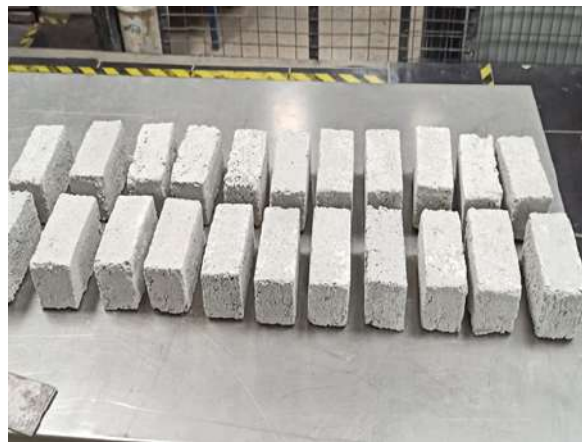
Fig. 3. Probetas de bloque.
