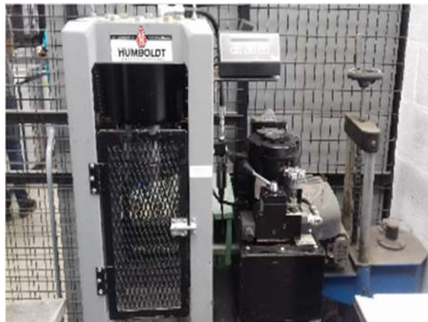
Fig. 4. Equipo Humboldt para ensayos de compresión.
