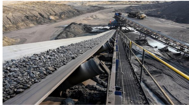
Fig. 4. Modelo de Cinta transportadora acanalada para el procesamiento de mineral de carbón [6].
