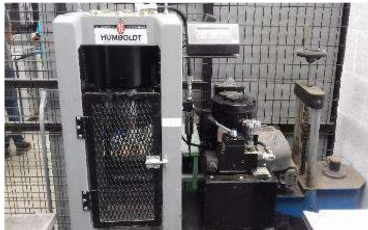
Fig. 2: Prensa Humboldt para ensayos de compresión.
