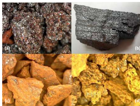
Fig. 4. Menas de hierro. (a) Finos Negros – Textura Friable en Microplacas, (b) Costra Hematítica – Textura Dura Bandeada, (c) Costra Masiva – Textura Dura Densa, (d) Costra Limonítica – Textura Blanda Terrosa. Aumento 50X.
