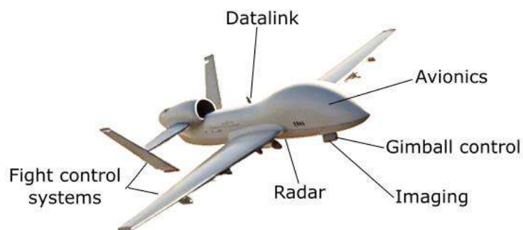
Fig1. Componentes básicos de drones militares para su navegación autónoma en operaciones militares.
