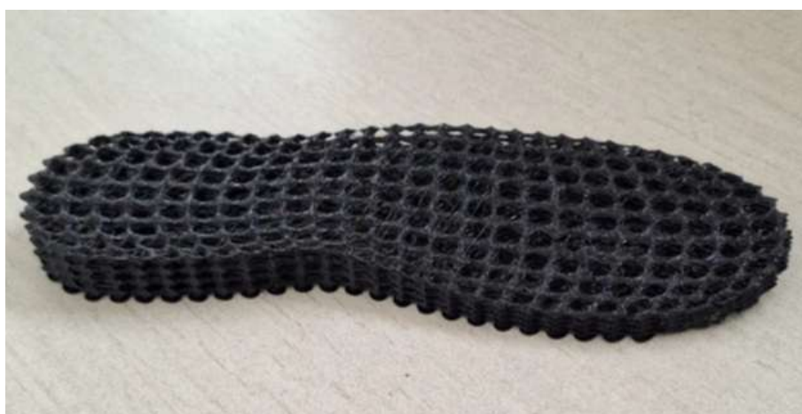
Fig. 3. Suela impresa en 3D mediante FGF.
