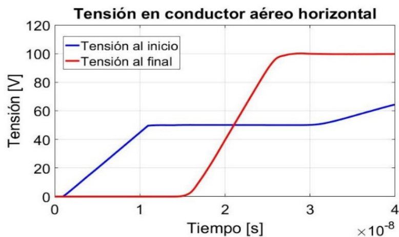
Fig. 12. Tensión al inicio y final de la línea obtenida por el autor
